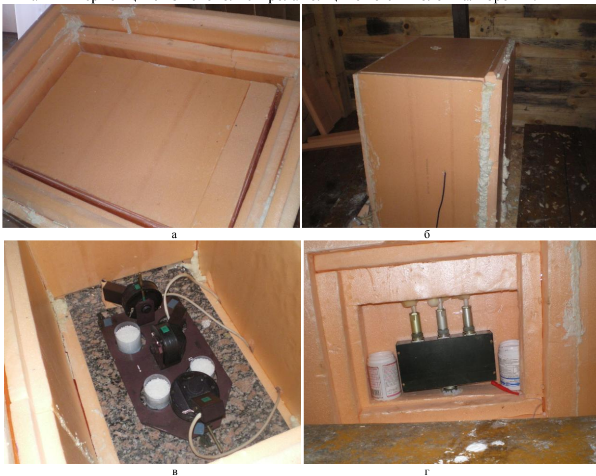
Рис.4. Термоизоляционная камера: а – нулевой контур, б – внешний вид, в – ЦМВС, г – блок усилителей.
